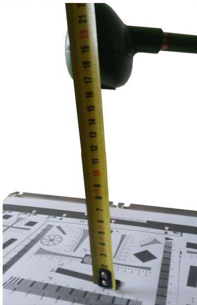
Figure 8: Distance entre bloc optique et feuille gluante
