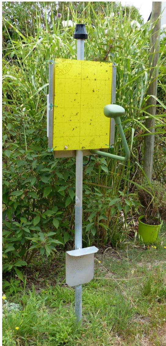
Figure 1: Vue générale du piège e-GLEEK
