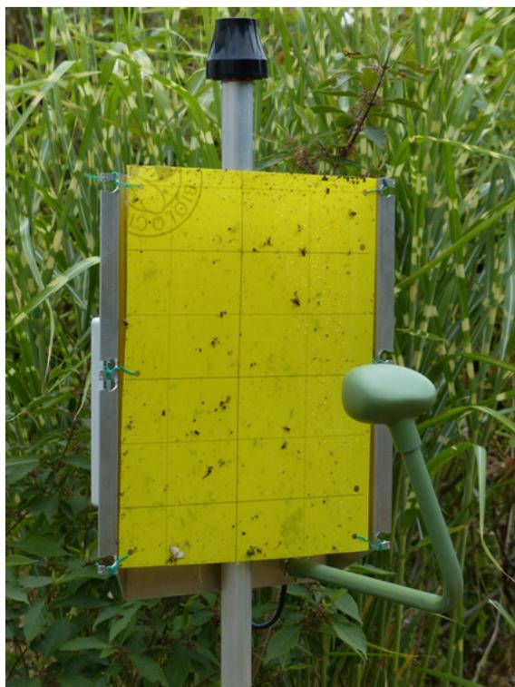
Figure 2: Une piège e-GLEEK® équipé d'une feuille gluante format A4
