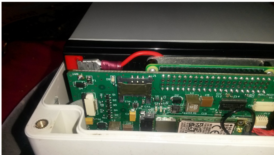
Figure 1: emplacement de la carte SIM
