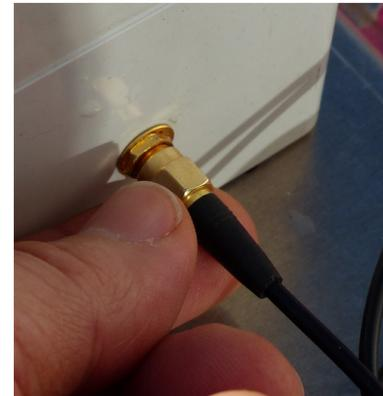
Insérez le câble de l'antenne dans le support à 90°
